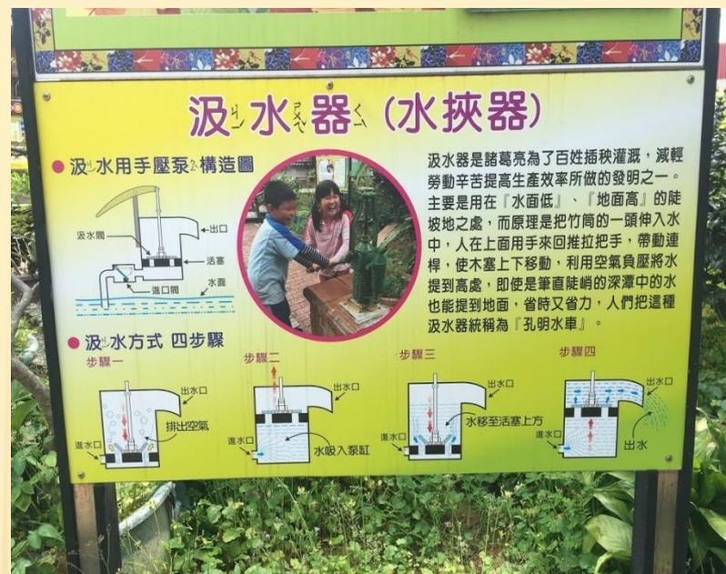
這個汲水器又叫「孔明水車」紀念諸葛亮減輕農民負擔的設計。水源來自校舍地底筏式儲水基礎，以及斜屋頂天溝雨水回收系統，是校園花圃灌溉水的主要來源。
